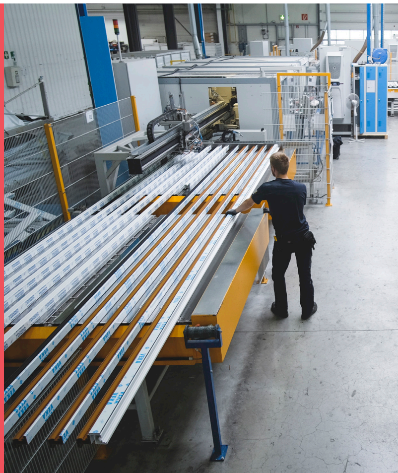
Ci-dessus : L'un de nos centres d'usinage 100% automatisé pour les profilés PVC. Ci-contre : notre table de travail pour des dimensions XXL (jusqu'à 6,5 m pour les coulissants !)
